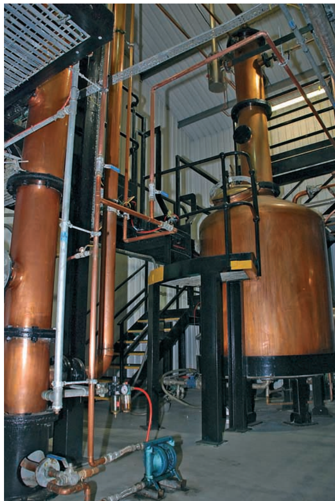
Die Welsh Pot Still wurde von Dr. David Faraday entwickelt. Sie gilt als einmalig in der Whisky-Industrie. „Je mehr Kupferkontakt, desto reiner das Destillat“, sagt Gillian Macdonald.
