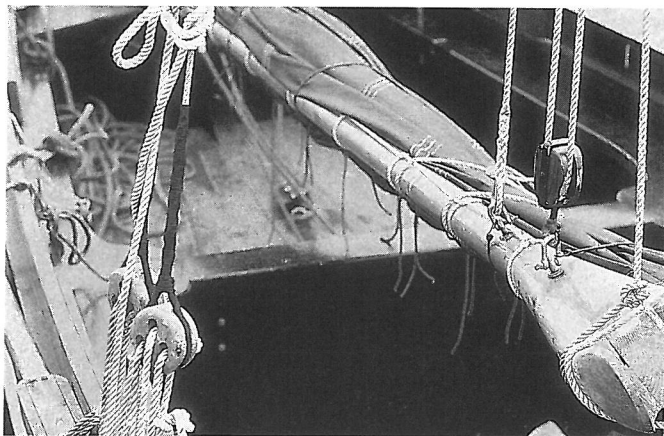
Gaffelkran und Steinballast der Star of the West
